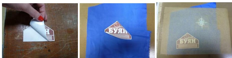
Рисунок 4 – Расположение термотрансферной бумаги на темной ткани
