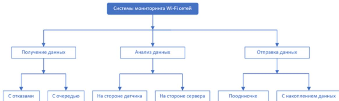
Рисунок 2 – Этапы, выполняемые в системе мониторинга Wi-Fi сетей
